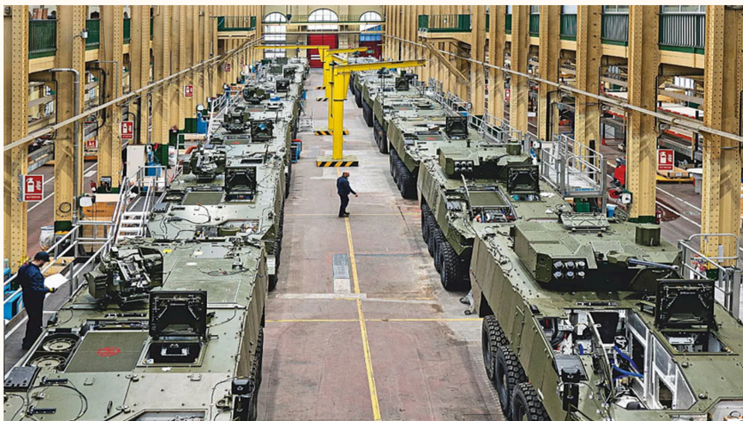
Línea de montaje de vehículos blindados 8x8 en la fábrica de Santa Bárbara Sistemas, en Trubia, España.
